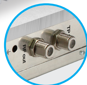
HF-Ausgang und Testpunkt zur Verbindung mit TV-Geräten oder einer Set-Top-Box mit DVB-T Tuner, bzw. zum Messen des Ausgangs- signals
